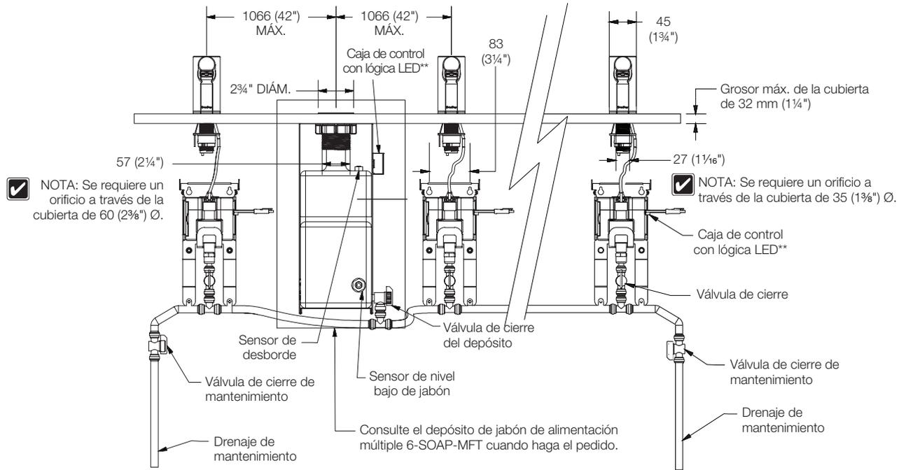
✓ \*\* NOTA: Se requiere batería o adaptador de CA. Se requiere una fuente de energía de CA a 1371 mm (54") de distancia de la caja de control.
