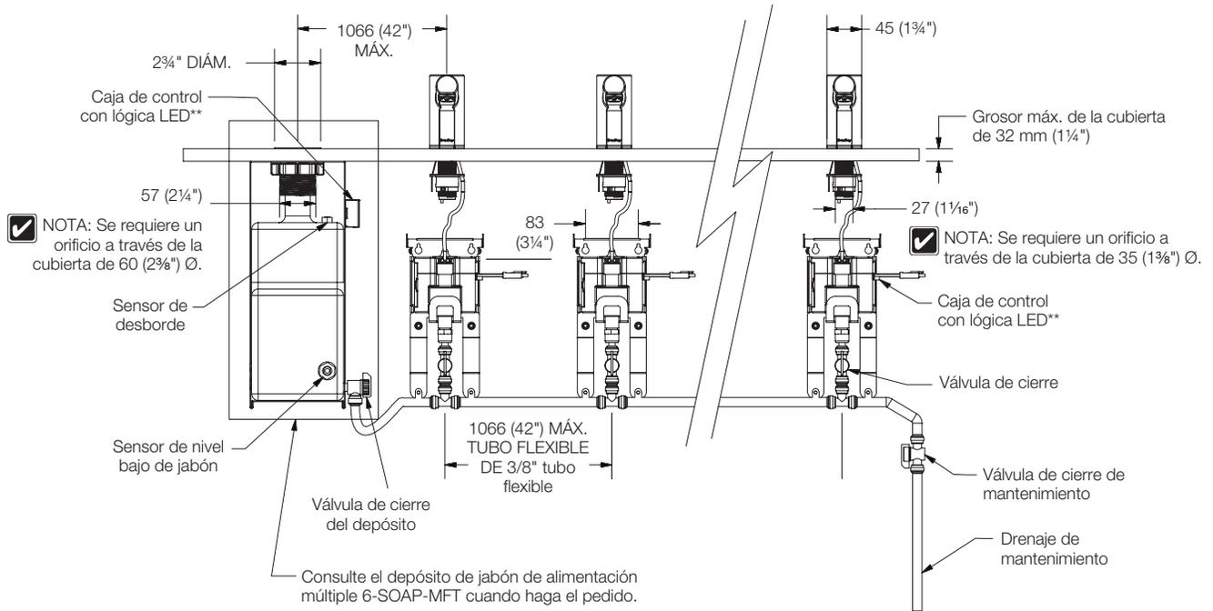
NOTA: Se requiere batería o adaptador de CA. Se requiere una fuente de energía de CA a 1371 mm (54") de distancia de la caja de control.
