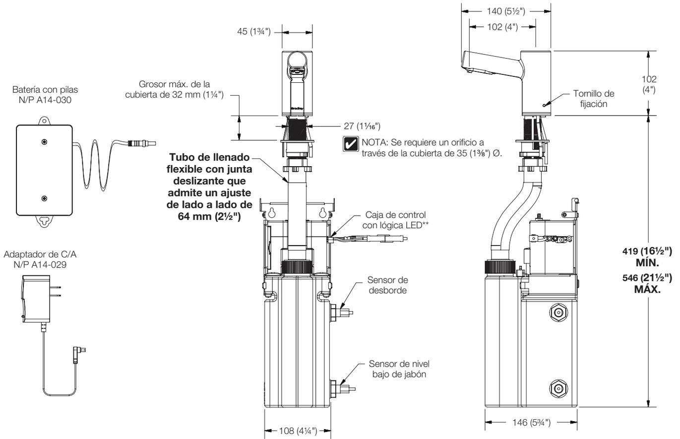
\*\* NOTA: Se requiere batería o adaptador de CA. Se requiere una fuente de energía de CA a 1371 mm (54") de distancia de la caja de control.
